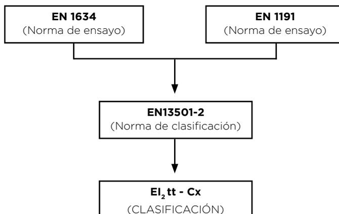
**E=** La integridad ó capacidad que tiene un elemento constructivo de soportar solamente en 1 cara sin que exista transmisión del fuego a la cara no expuesta debido al paso de llamas ó gases.
